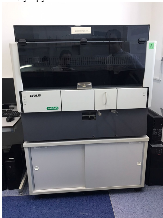
Рисунок 4- Система автоматизации ИФА-исследований BioRad
